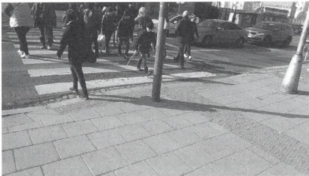
Pohled na řešený přechod – bude zřízen vodící pás přechodu v ose přechodu, včetně doplnění reliéfní dlažby na okrajích vozovky, navázání na umělou vodící linii v parku i na opačné straně.
