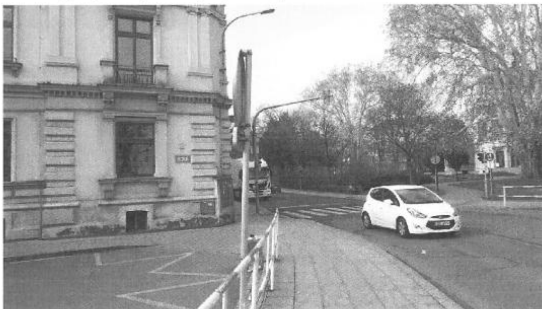
Pohled na místo zřízení sdruženého přechodu a přejezdu, prodlouží se varovný pás do výšky + 8 cm nad niveletu vozovky, zřídí se varovné pásy a zábradlí se doplní o vodící linii pro nevidomé.
