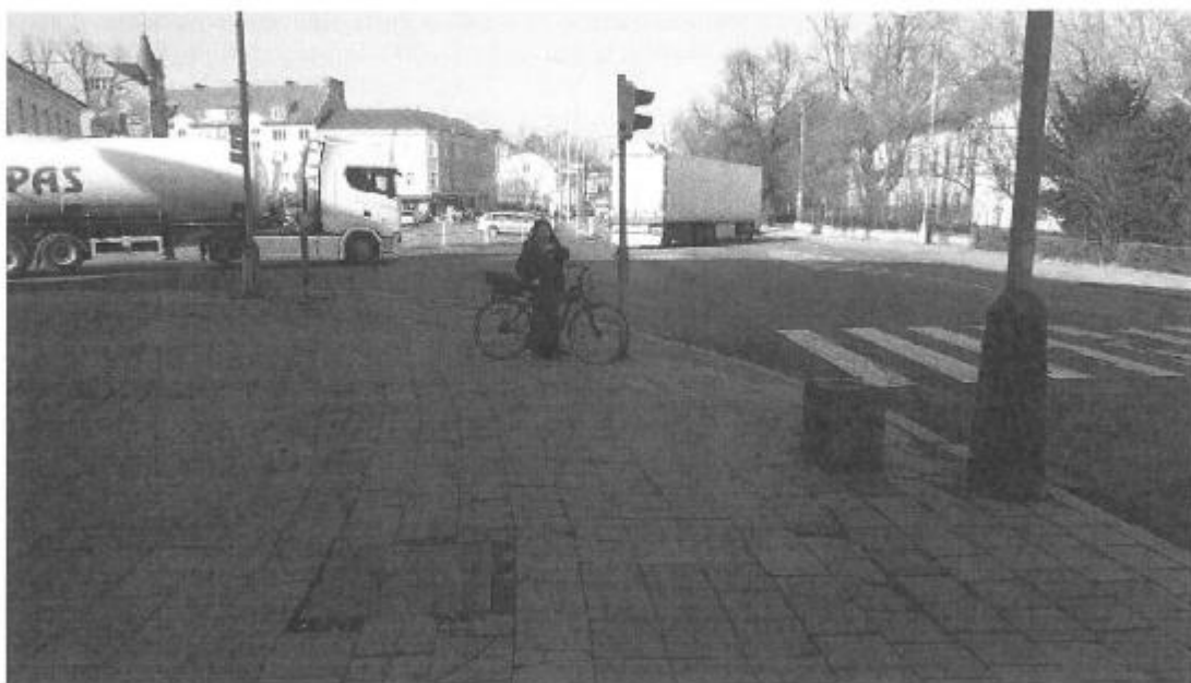
Pohled na jeden z řešených přechodů – bude prodloužen státní pás a napojena na vodící linii, zřídí se vodící pás přechodu v ose přechodu, včetně doplnění reliéfní dlažby na okrajích vozovky.
