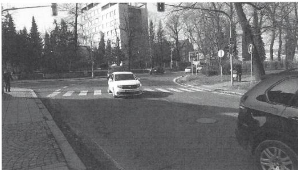
Pohled na řešený přechod – bude zřízen vodící pás přechodu v ose přechodu, včetně doplnění reliéfní dlažby na okrajích vozovky, navázání na umělou vodící linku v parku.
