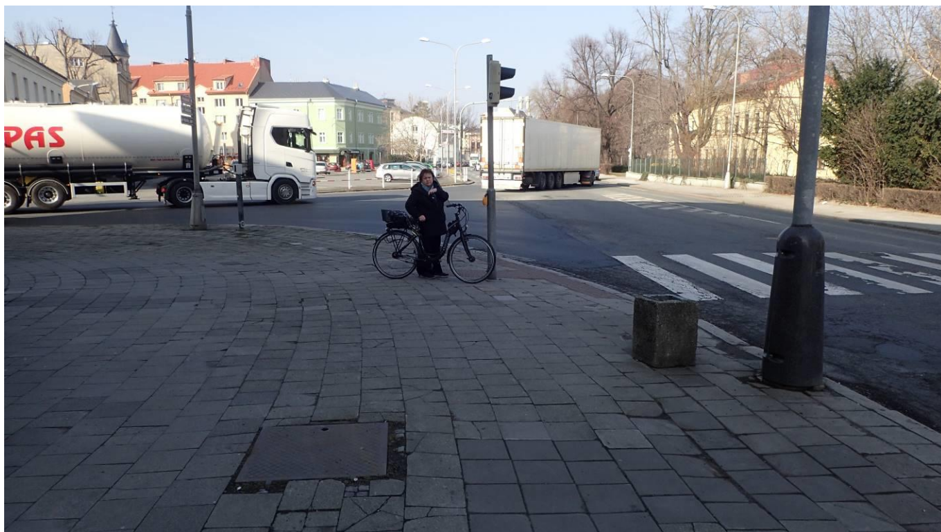
Pohled jeden z řešených přechodů – bude prodloužen signální pás a napojena na vodící linii, zřídí se vodící pás přechodu v ose přechodu, včetně doplnění reliéfní dlažby na okrajích vozovky.
