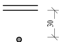
KŘÍŽENÍ KABELU NN S KANALIZACÍ, TEPOVODY (cm)
